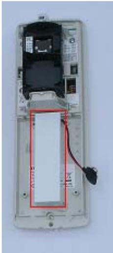
**CARATTERISTICHE GENERALI :** questa scheda radiotrasmettente può essere inserita in rivelatori di qualunque tipo onde ottenere una segnalazione di allarme via radio compatibile con tutte le centrali o ricevitori Silentron. Fare riferimento alle istruzioni specifiche del rivelatore per quanto riguarda il funzionamento e le regolazioni, nonché alle istruzioni della presente scheda 0416 per la parte di comunicazione.
